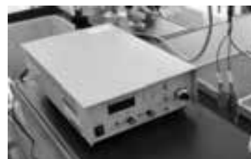
図 1 電源装置および測定機器 ガルバノスタット (北斗電工 HA-151A) 電流値を一定に制御できる。
