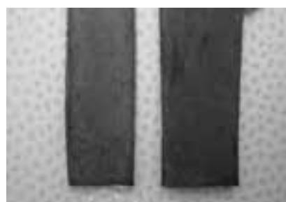
図 10 完全放電(左) 不完全放電(右)した正極板写真 右の方が \text{PbO}_2 が多く付着している
